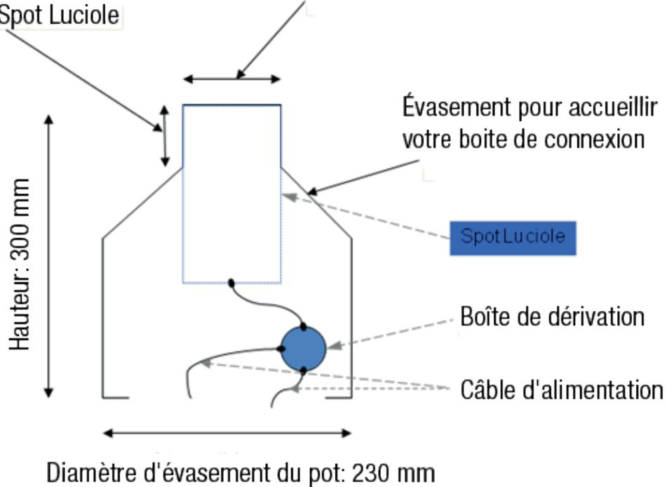
Diamètre d'évasement du pot: 230 mm
