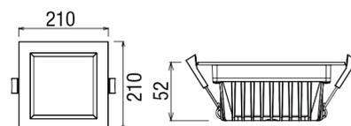
Diamètre d'encastrement 140 x 140 mm
