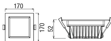
Diamètre d'encastrement 125 x 125 mm
