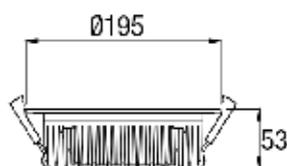
Diamètre d'encastrement Ø 210 mm
