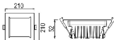
Diamètre d'encastrement 140 x 140 mm
