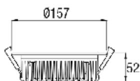
Diamètre d'encastrement Ø 170 mm
